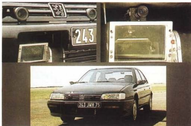
Fig. 13: Le telecamere ed il radar del sistema di visione artificiale alloggiato su una 605 utilizzato per la determinazione di ostacoli sulla carreggiata.
